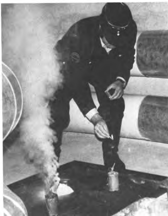
Un "bombero" enciende un cartucho de humo para simular una condición de incendio.
