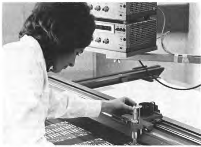
La operaria inspecciona un circuito que en la etapa final de producción habría de quedar reducido fotográficamente al tamaño de la cabeza de un alfiler.
