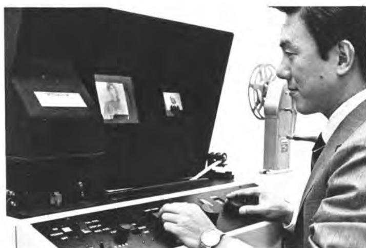
Yoshihiko Masuda hace correcciones en el analizador Eastman de negativos en color para obtener un correcto balance cromático en la imagen proyectada.
