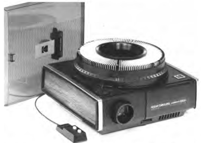
El nuevo proyector Kodak Carousel Custom 840H, de enfoque automático, tiene elegante estilo, con paneles de vinilita que simulan madera, una cubierta protectora, una manija cromada retráctil, cordón eléctrico fijo, un compartimento para éste y una cubierta corrediza para el lente. Esta unidad proyecta diapositivas de 5 x 5 cm. en portadiapositivas de 80 y 140 casillas. Permite el cambio de vista en avance o retroceso por medio de botones y por control remoto. El sistema eléctrico es para corriente alterna de 110/125 voltios a 60 Hz.
